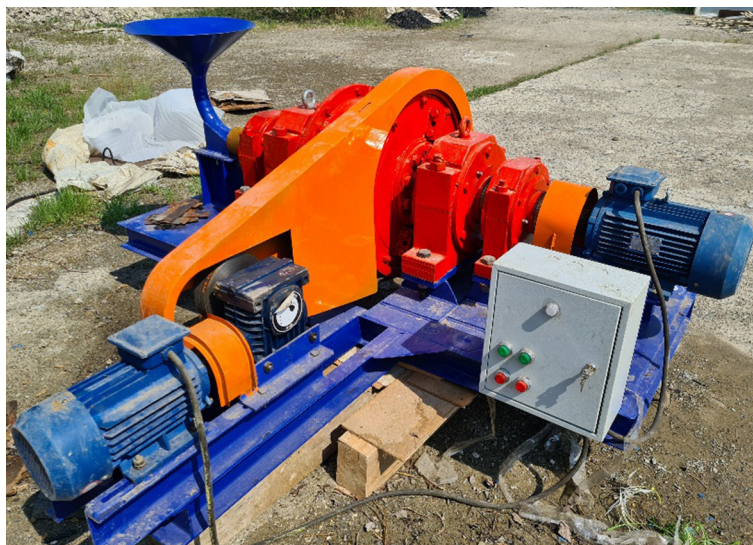
Рис. 3. Опытно-промышленный образец мельницы роторной МДР / Fig. 3. Pilot-industrial sample of the rotary mill MDR
